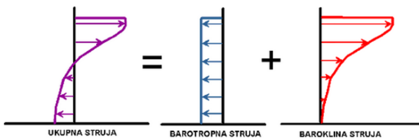
Slika 3.11 Shematski prikaz rastavljanja struja na komponente (izvor: http://skola.gfz.hr/ )
