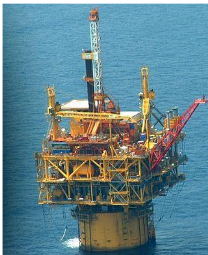
Slika 1.10 Plutajuća platforma u obliku valjka (izvor: http://en.wikipedia.org )
