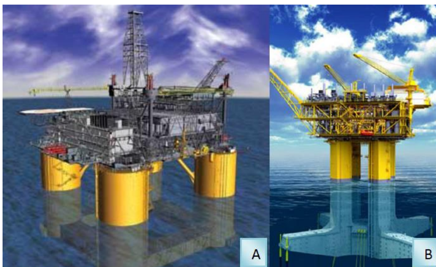
Slika 1.8 Plutajuće platforme s nategom u nogama usidrene na morskom dnu (izvori: slika lijevo ( http://www.offshore-mag.com )
