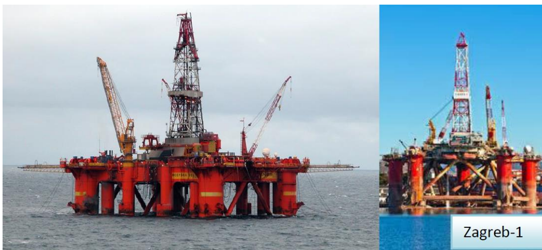
Slika 1.11 Poluuronjive platforme (izvor: http://en.wikipedia.org )
